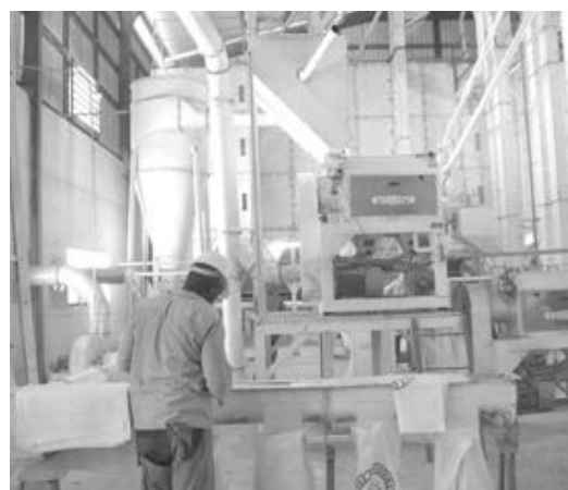
Segundo secadero Zaccaría, de factura brasileña, de 56 toneladas de capacidad, en La Paqueta. FOTO DEL AUTOR
